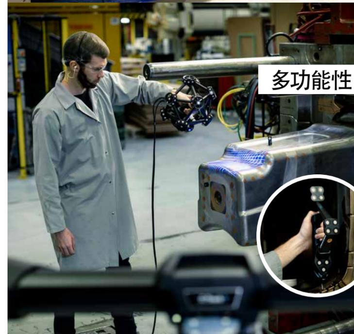
MetraSCAN 3D 用途广泛，一台设备可实时扫描各种尺寸和表面粗糙度的零部件。因其可扩展的测量范围，任何形状、复杂性和几何形状的零部件都能轻松测量，不损失精度、无需传统的蛙跳。当与 HandyPROBE 配合使用时，该测量系统的用途更为广泛：探测几何实体和对整个表面检测进行 3D 扫描。
